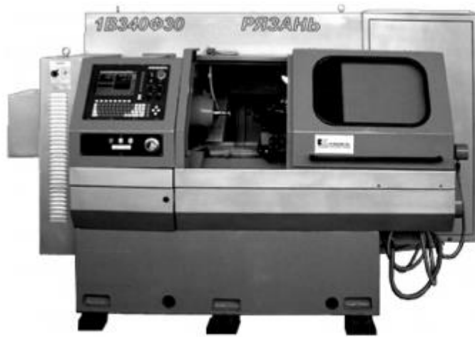
Рис. 22. Станок токарно-револьверный патронно-прутковый с ЧПУ 1В340Ф30
